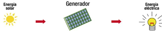
La solar fotovoltaica es la tecnología más sencilla que existe para generar electricidad: basta con aplicar la radiación solar sobre un panel para obtener energía eléctrica, con el único coste para el usuario de su instalación.
